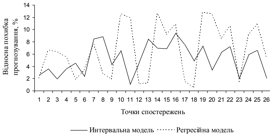
Рис. 6. Відносна похибка прогнозування для інтервальної та регресійної моделей.
