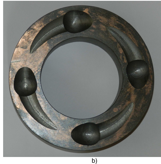
Fig. 2 - The constructive scheme (a) and the general form (b) of the working surface of the driving half-clutch of a safety device / Конструктивна схема (a) та загальний вигляд (б) робочої поверхні ведучої півмуфти запобіжного пристрою
