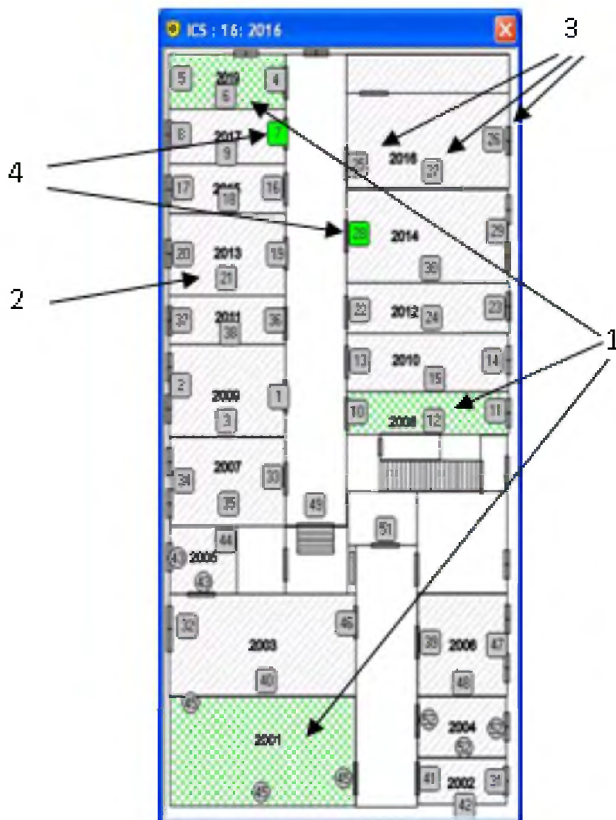
Рис. 4.12. Карта розміщення сповіщувачів НДІ ІКС в програмі Guard64.
