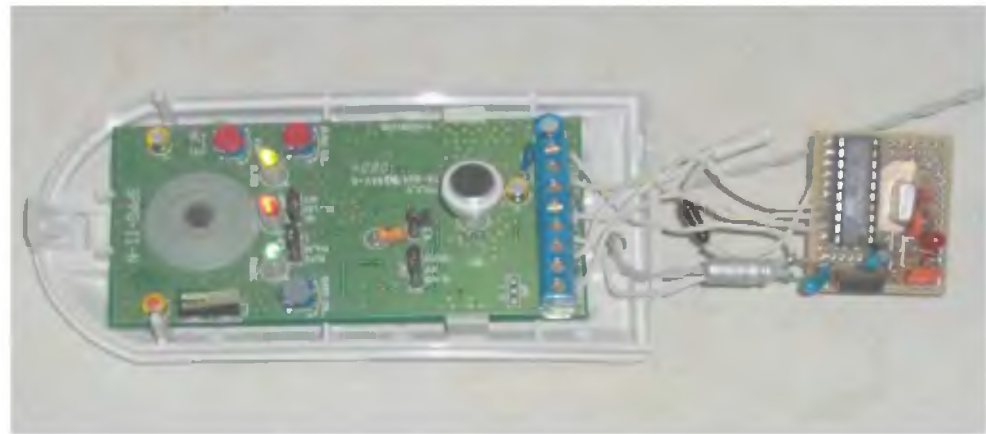
Рис. 4.11. Сповіщувач SRPG-2N з приєднаним мережевим контролером
