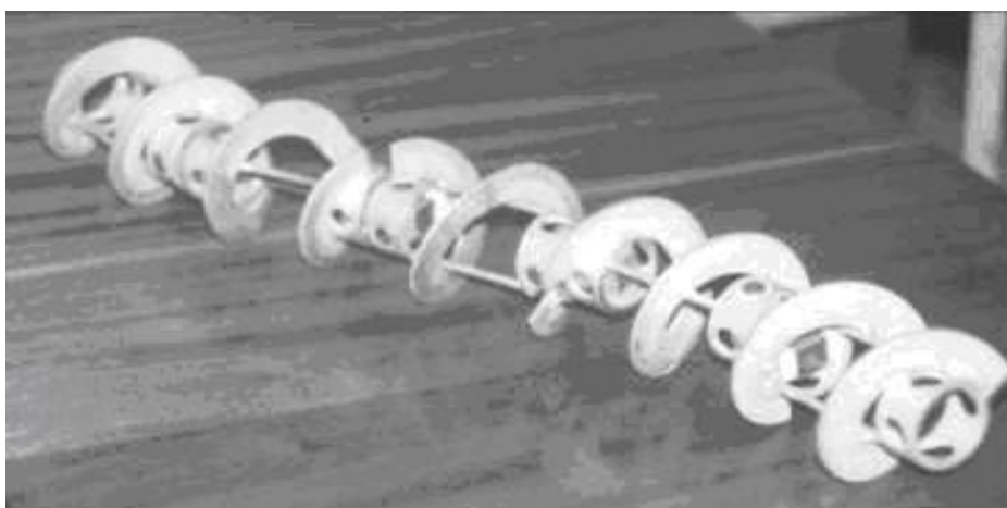
Рис. 5.8. Загальний вигляд окремих секцій гвинтового робочого органу соковитискача
