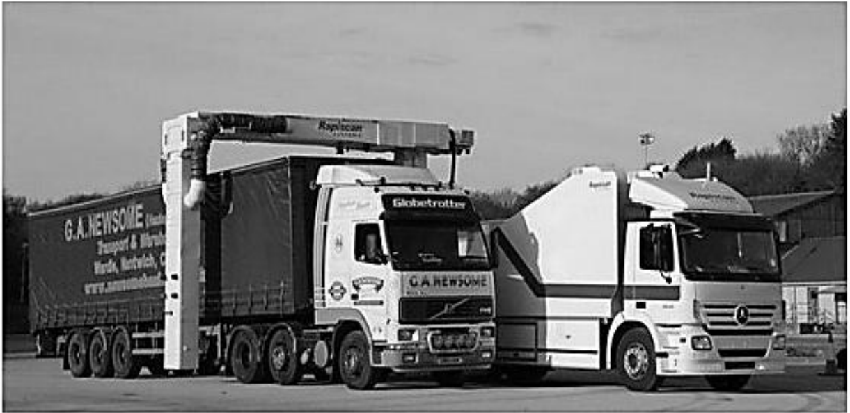
Рис. 3.1 Мобільна установка типу RapiscanEagleM [7].
