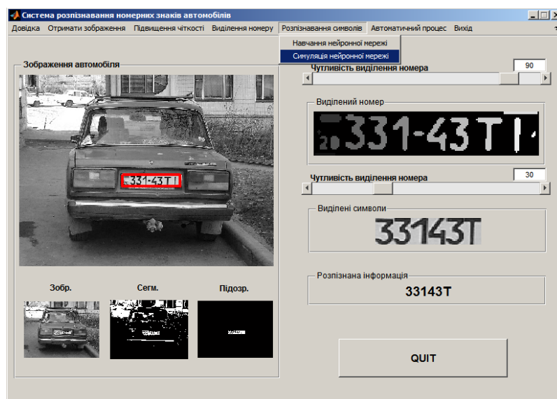
Рисунок 3.23 – Розпізнавання символів номерного знаку автомобіля
