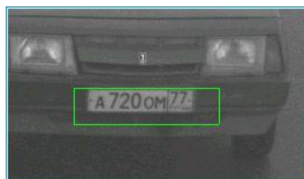
Рисунок 1.9 – Виділення номеру автомобіля системи "MegaCar"
