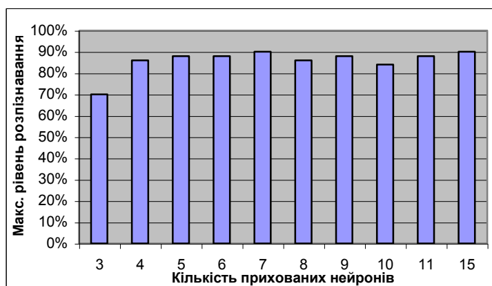
Рисунок 3.14 – Залежність між кількістю прихованих нейронів і рівнем розпізнавання символів нейронною мережею
