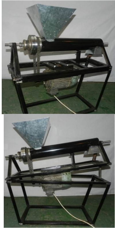
Рис. 4 – Загальний вигляд стану для дослідження шнекового транспортера із запобіжним пристроєм
