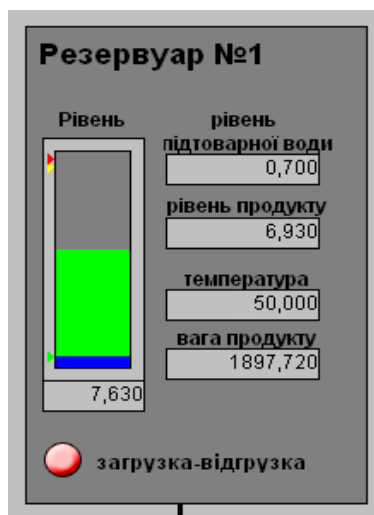
Рисунок 3.10 – Панель керування резервуаром
