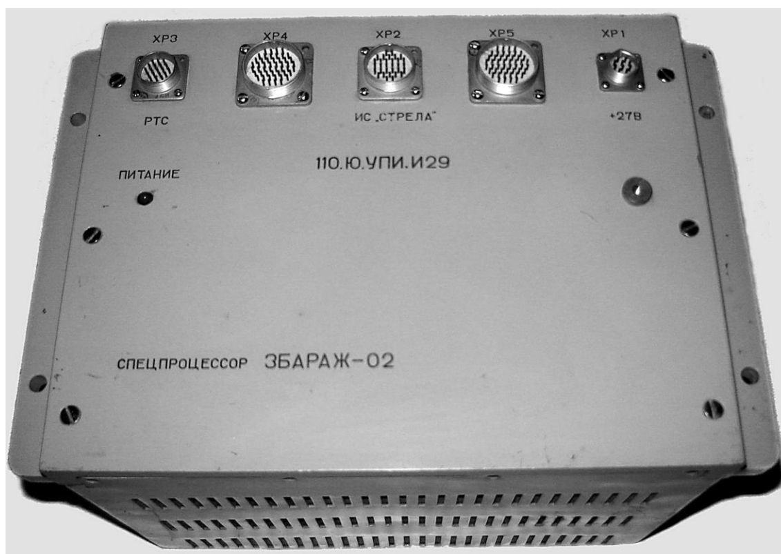
Рис. 1. Бортовий спеціалізований процесор “ЗБАРАЖ-02” для ОС типу “МИР” та “МКС”.
