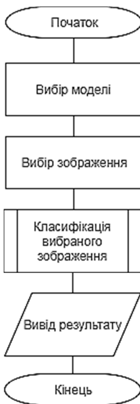
Рисунок 3.2 – Блок-схема алгоритму роботи модуля тестування згорткової нейронної мережі
