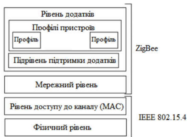
Рисунок 1.4 – Стек протоколів ZigBee
