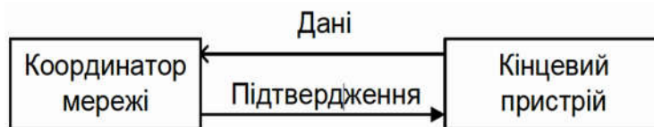
Рисунок 2.3 – Обмін даними з координатором без використання маяків
