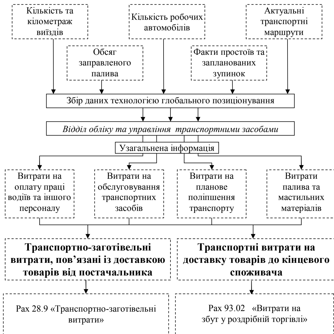
Рис. 2.10. Послідовність формування інформації про роботу автотранспортної служби з використанням технології глобального позиціонування [Розроблено автором]
