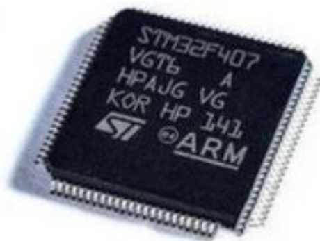
Рисунок 3.2 - Зовнішній вид мікроконтролера STM32F407VGT6
