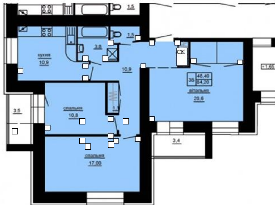
Рисунок 4.10 – Схема роботи датчиків інтелектуальної системи освітлення
