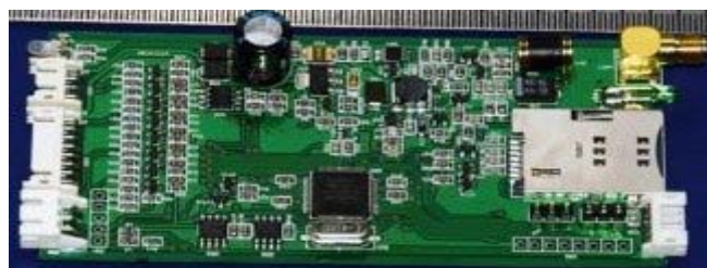
Рисунок 1.16- Системна плата автомобільної сигналізації X-Keeper Drive V3
