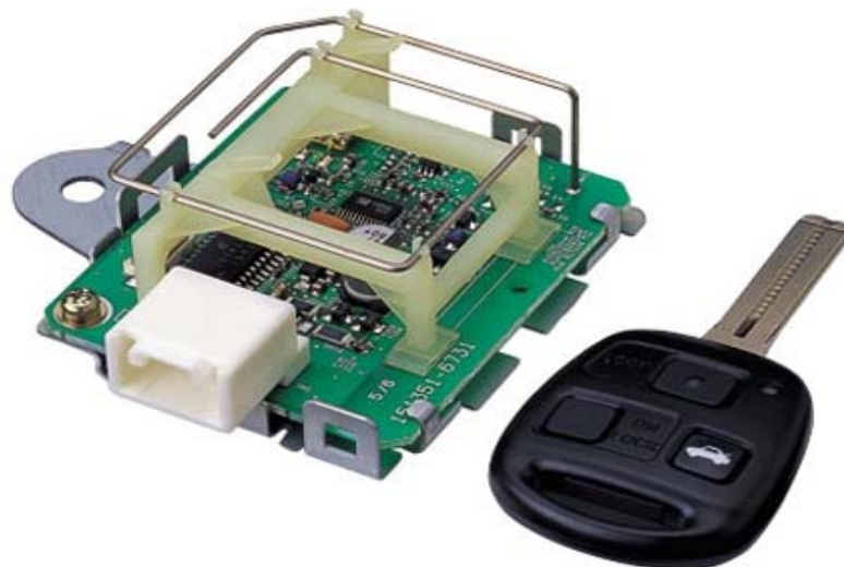
Рисунок 2.1- Системна плата контактної іммобілайзера та ключ його деактивації
