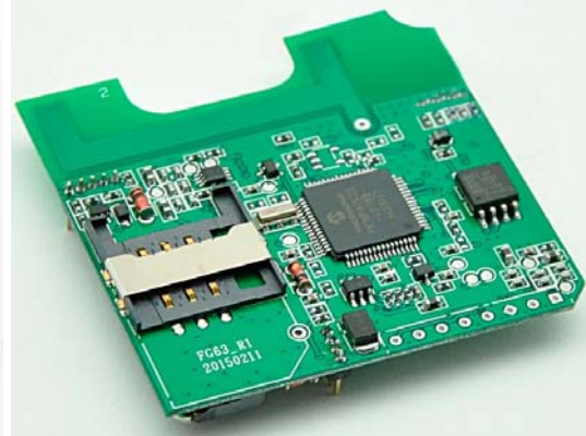
Рисунок 2.18- Пристрій глобального моніторингу на основі GPS і GSM модулів Starline M32T (а), та GSM модуль(б)
