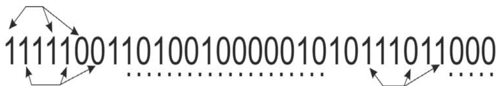
Рисунок 4.3-Формування коду Галуа при n=5
