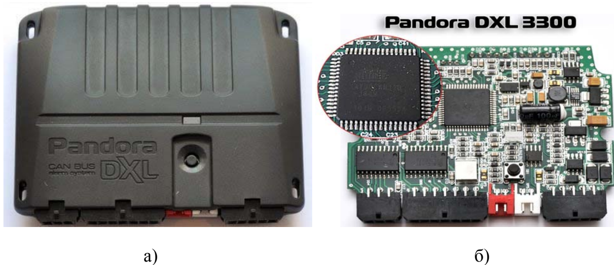
Рисунок 1.13- Центральний блок (а) та плата (б) автомобільної сигналізації Pandora DXL 3300
