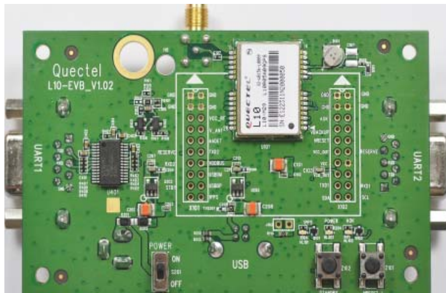
Рисунок 2.15- Системна плата з модулем GPS Quectel L10
