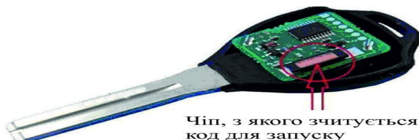
Рисунок 2.3- Плата ключа деактивації іммобілайзера з чіпом зчитування коду запуску
