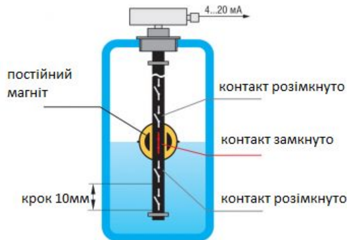
Рисунок 3.6 - Принцип дії та особливості конструкції ПДУ-И
