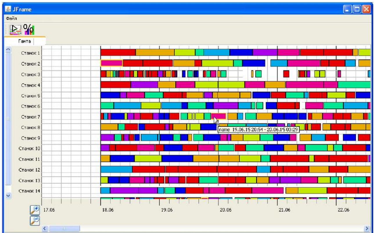
Рис.1.10. «Приклад побудови розкладу для обробки на верстатах в системі планування»
