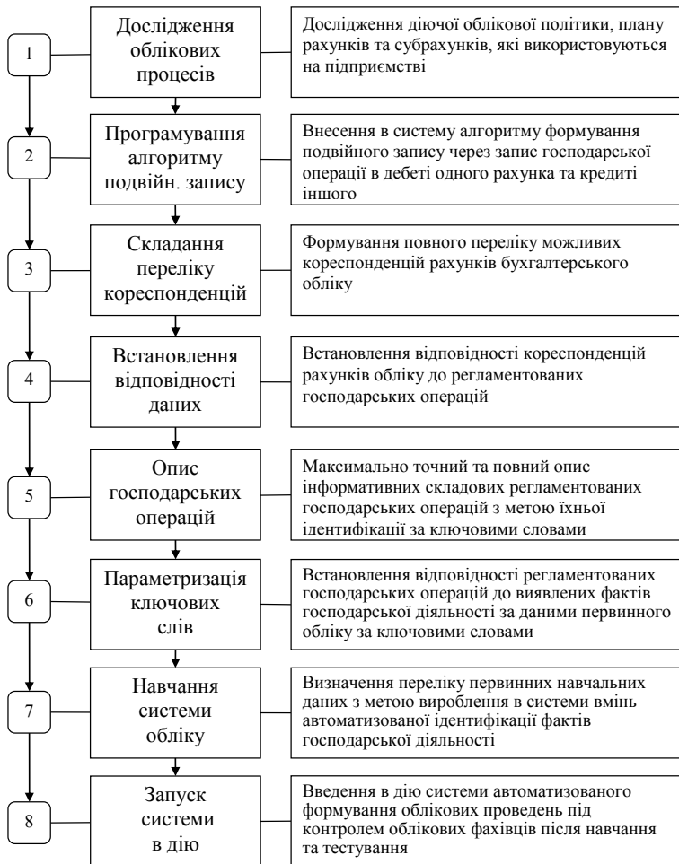
Рис. 3.7. Послідовність дій із налаштування та введення в експлуатацію системи автоматизованого формування облікових записів
