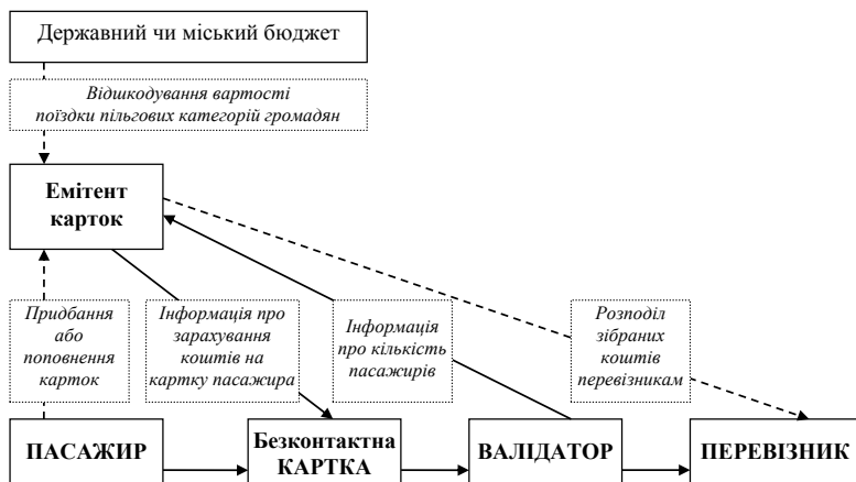
Рис. 4.14. Схема інформаційних і грошових потоків в комп'ютеризованому обліку діяльності транспортних підприємств
