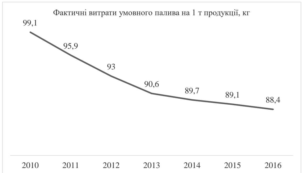
Рис. 2.11. Динаміка фактичних витрат умовного палива на виробництво тони хліба та хлібобулочних виробів в Україні за 2010 – 2016 рр.
