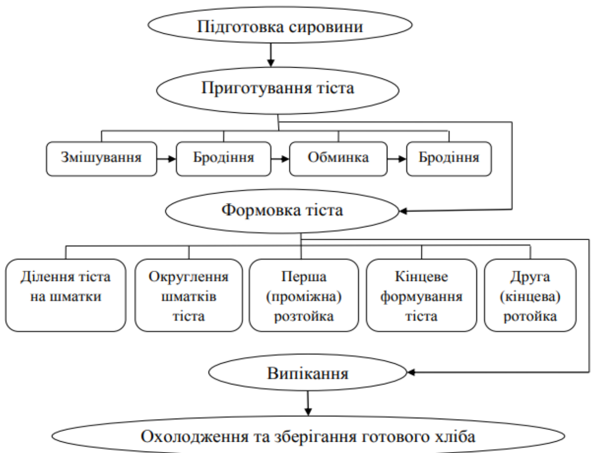
Рис. 6. Схема послідовності технологічних операцій процесу виробництва хліба
