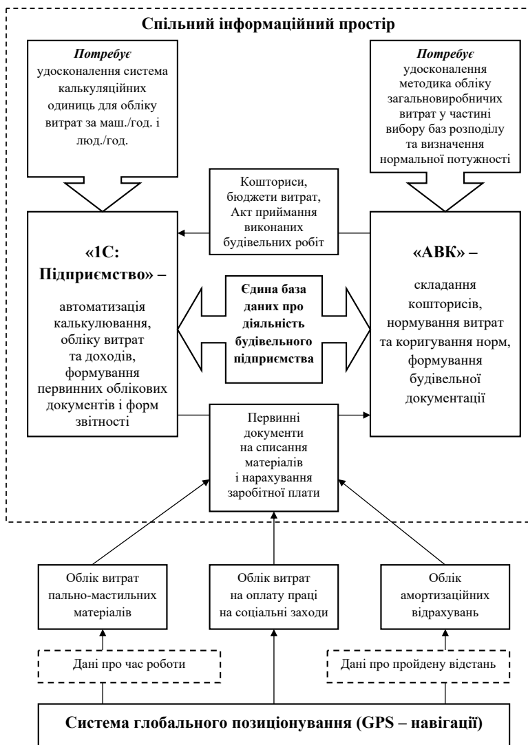
Рис. 1. Схема інформаційного обміну та синхронізації між програмними продуктами для автоматизації діяльності будівельних підприємств
