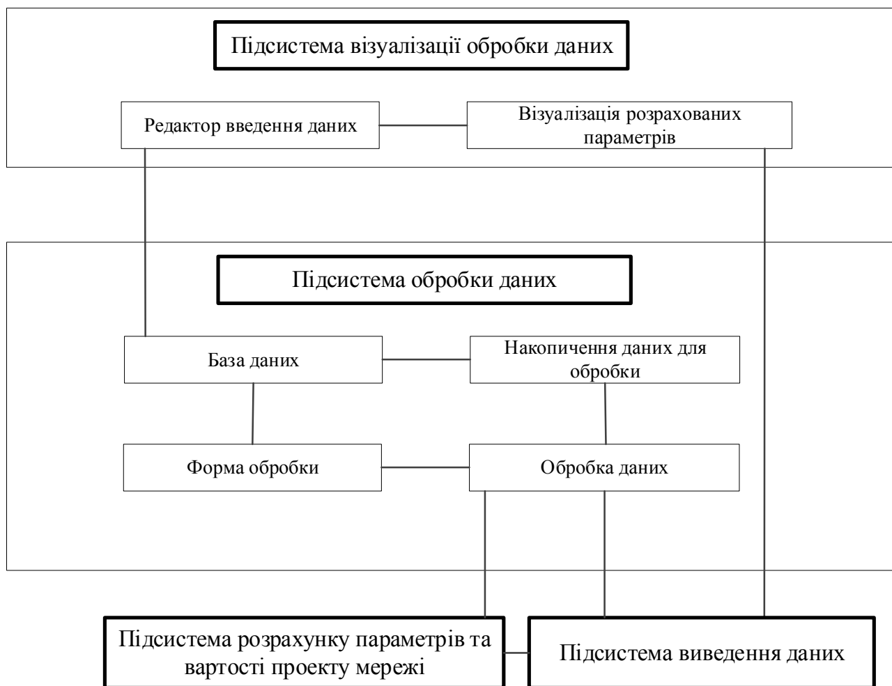
Рисунок 2.3 – Структурна схема програмного продукту
