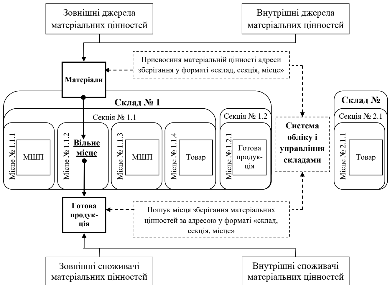
Рис. 2.5. Схема матеріальних та інформаційних потоків системи обліку та управління складом «хаотичне зберігання»
