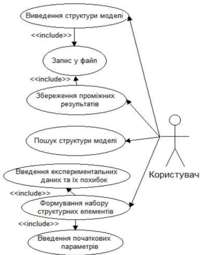
Рисунок 3.3 – Функціональну модель розробленої програмної системи для моделювання процесів анаеробного мікробіологічного бродіння
