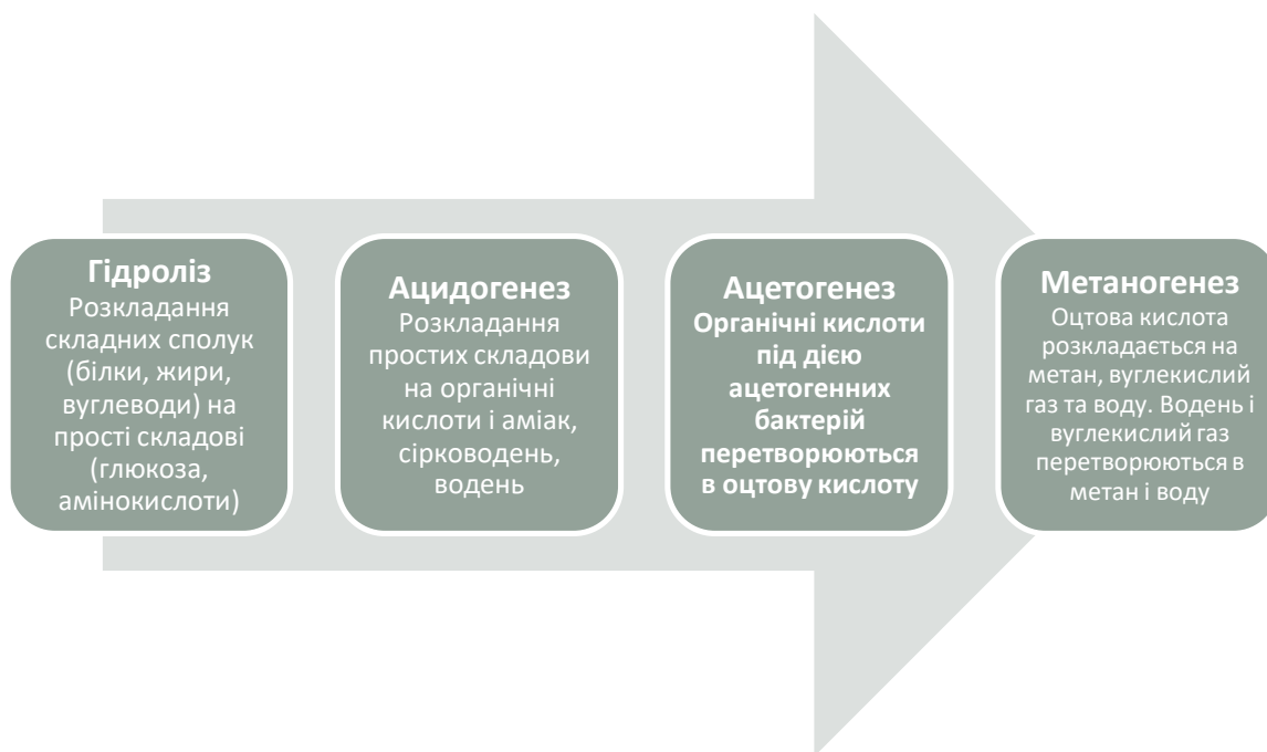
Рисунок 1.2 – Схема біохімічного процесу утворення біогазу
