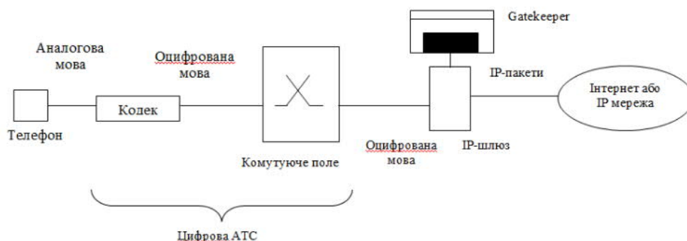
Рисунок. 1.8. – Положення шлюзу в мережі IP-телефонії
