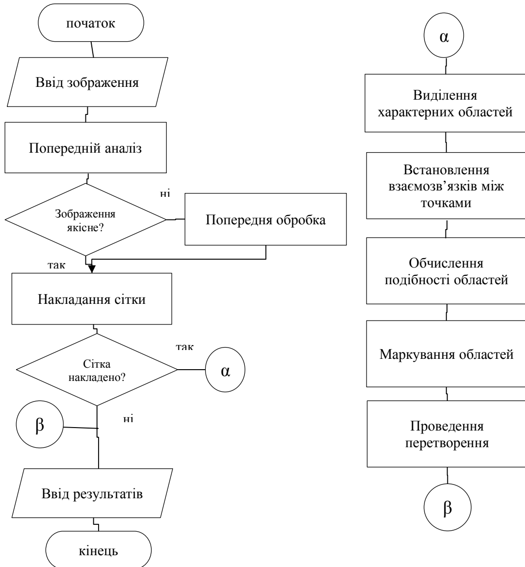
Рисунок 2.12 – Блок-схема алгоритму перетворення елементів на зображенні
