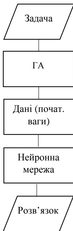
Рисунок 2.11 – Допоміжне об'єднання генетичного алгоритму з нейронною мережею
