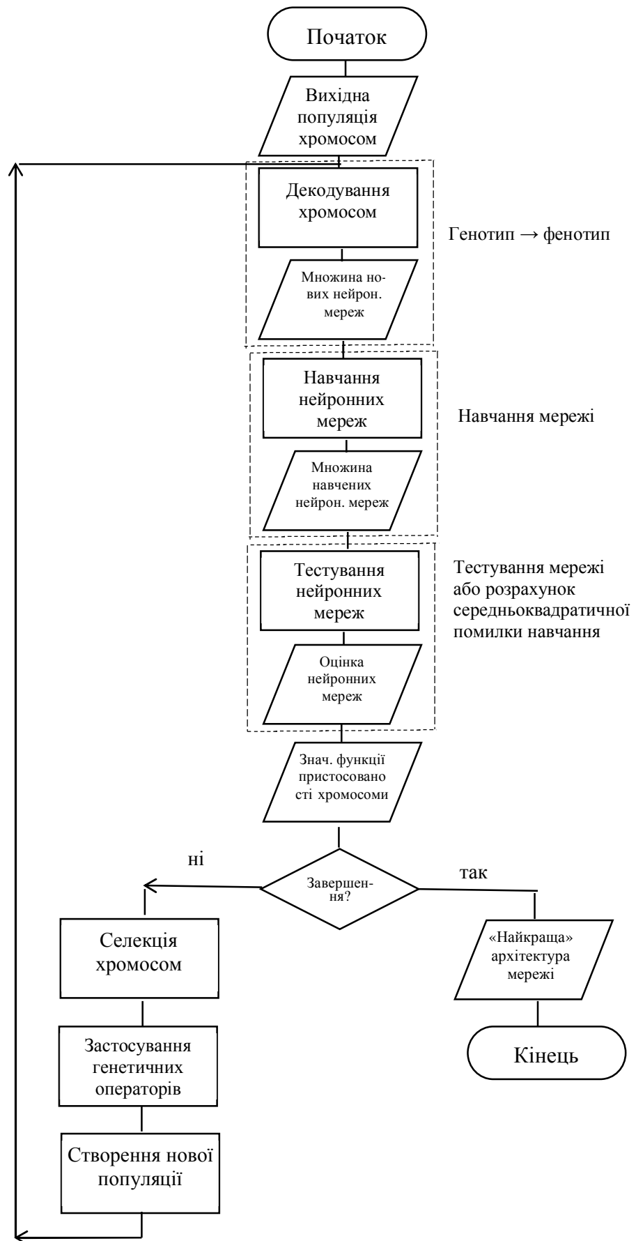
Рисунок 2.13 – Блок-схема генетичного алгоритму для пошуку найкращої архітектури нейронної мережі (випадок еволюції архітектур)
