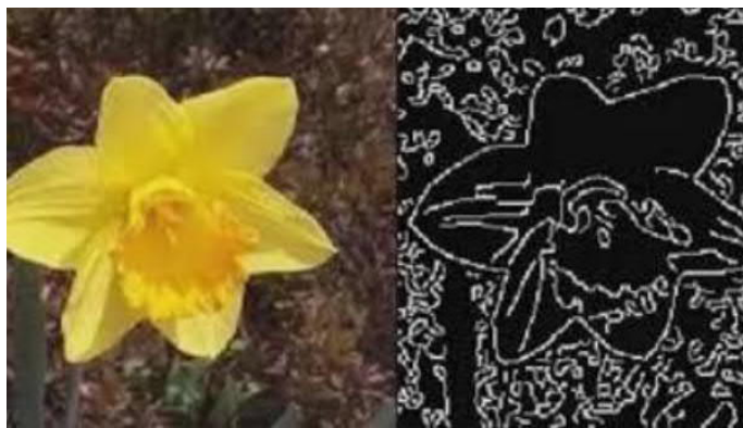
Рисунок 1.4 – Приклад виділення границь методом похідних
