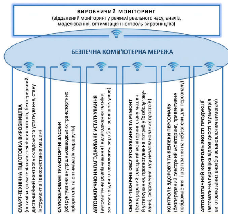
Рис. 2.10. Типова схема смарт-заводу на базі ІоТ
