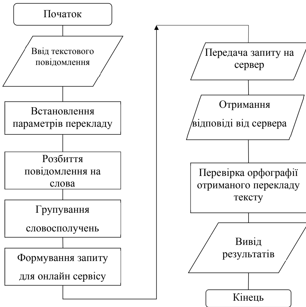
Рисунок 2.3 – Блок схема алгоритму перекладу текстової інформації на основі використання онлайні сервісів
