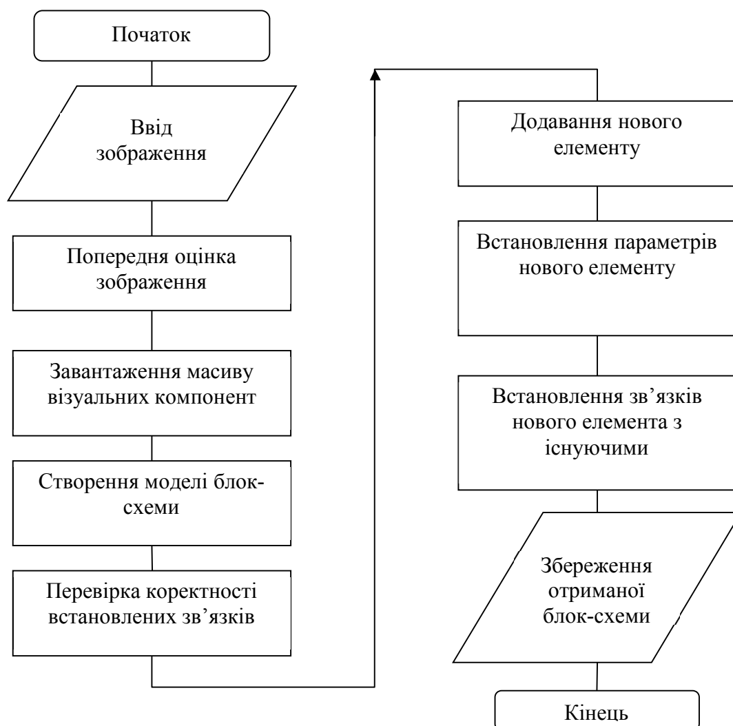
Рисунок 2.3 – Блок-схема алгоритму додавання нового елемента до блок-схеми алгоритму
