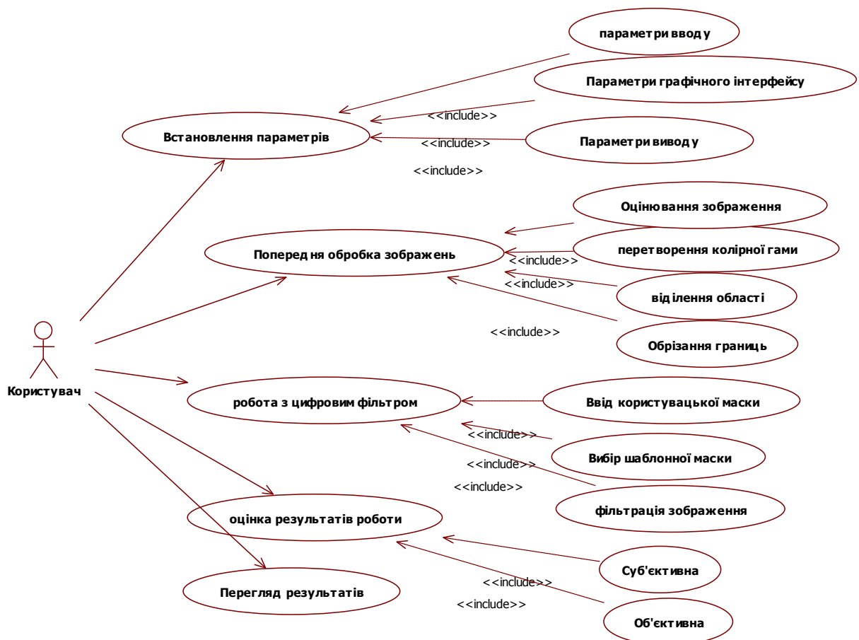
Рисунок 3.2 – Діаграма прецедентів програмного додатку обробки зображень на основі цифрових фільтрів
