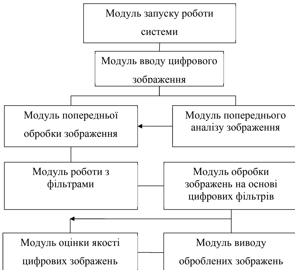
Рисунок 3.1 – Структура програмного додатку обробки цифрових зображень
