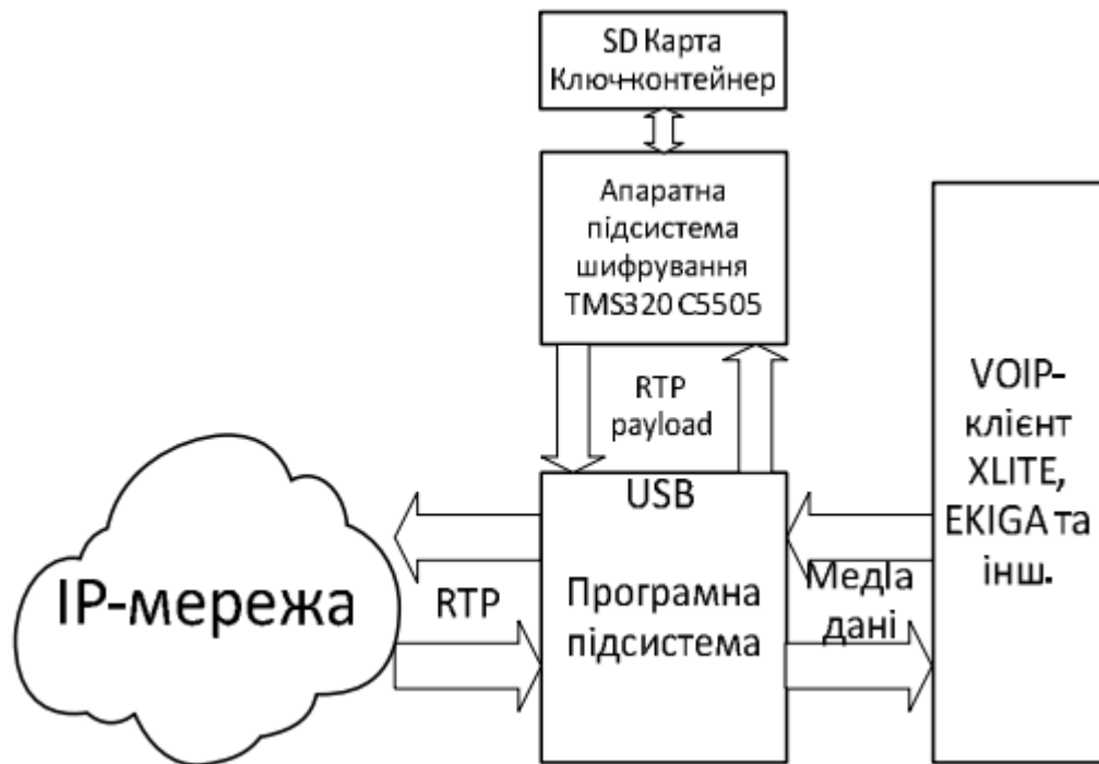
Рисунок 3.3 - Загальна схема роботи пристрою захисту
