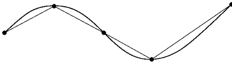
Рисунок 2.3 – Апроксимація синусоїди до полігональної кривої
