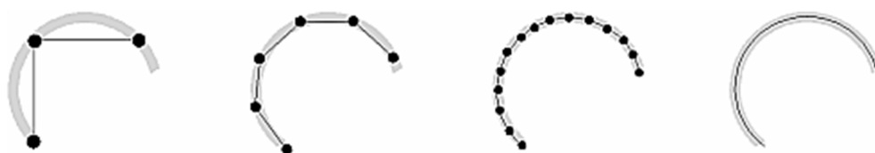
Рисунок 2.4 – Приклади апроксимації кривої з різними значеннями \varepsilon
