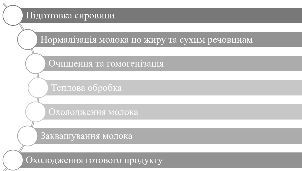
Рис. 3. 4 Етапи приготування безлактозного молока резервуарним способом
