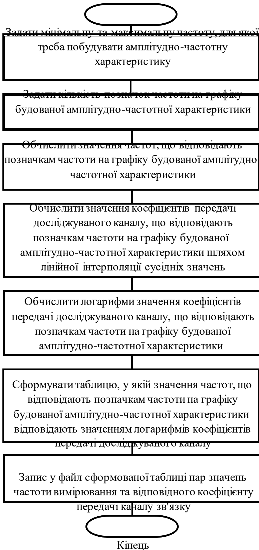
Рисунок 3.3 - Алгоритм роботи комп'ютера під час побудови амплітудночастотної характеристики дослідженого каналу зв'язку або фільтра.
