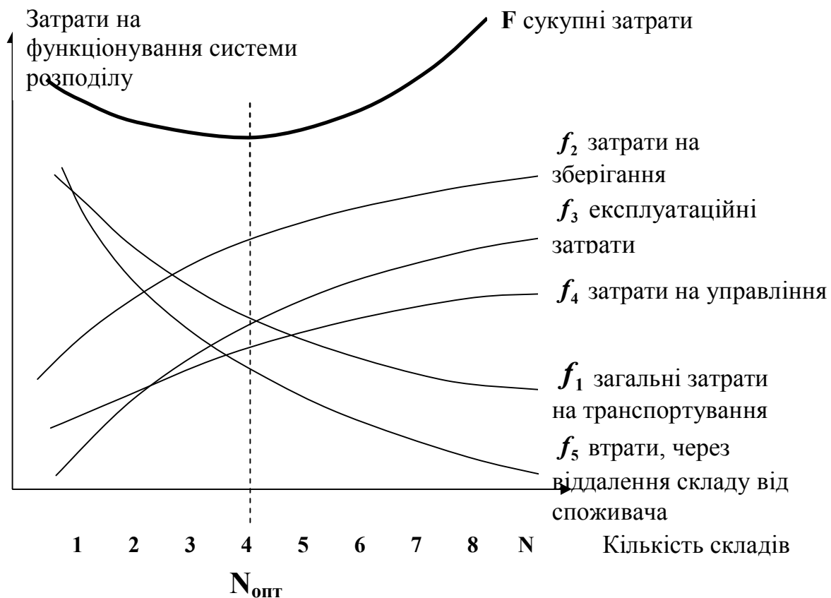
Рис. 9.3. Залежність сукупних затрат на функціонування системи розподілу від кількості складів, що входять до неї
