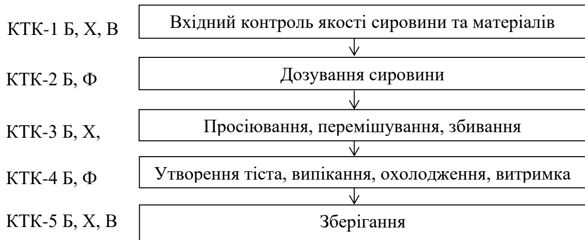
Рисунок 1. Критичні контрольні точки виробництва бісквітного напівфабрикату з використанням борошна льону
