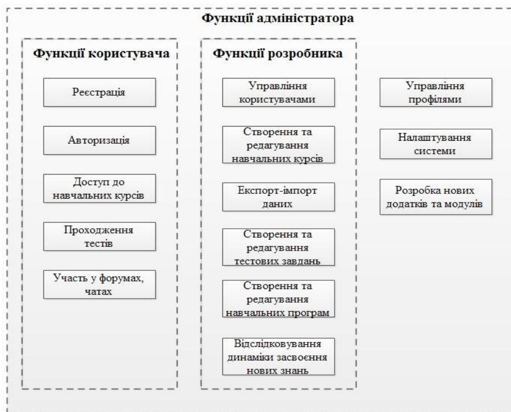
Рис. 4.5. Структурна схема модуля
