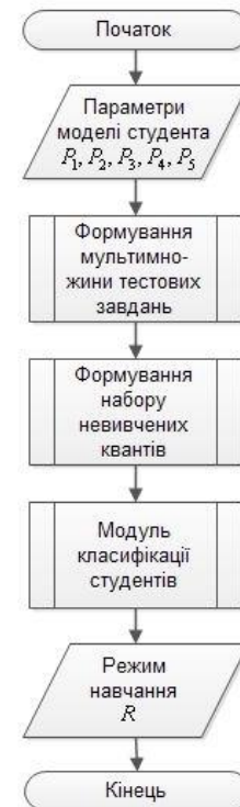
Рис. 3.21. Блок-схема алгоритму мультимножинного аналізу
