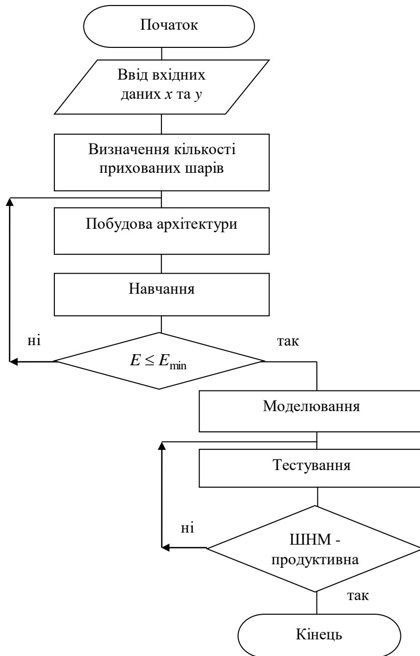
Рисунок 2.15 – Блок схема алгоритму моделювання архітектури нейромережі
