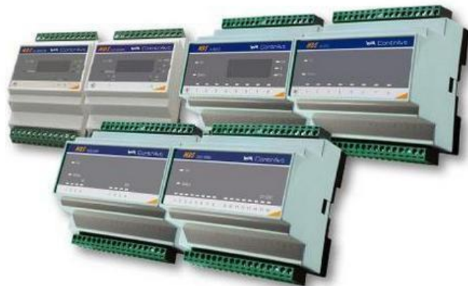
Рисунок 2.3 – Модулі введення-виведення аналогових MDS-AIO,-AI, -AO, та дискретних MDS-DIO,-DI,-DO сигналів, а також перетворювачі інтерфейсів MDS-IC-USB/RS485/RS232
