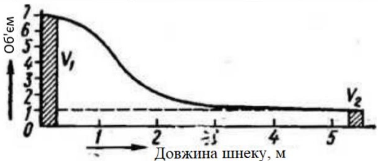
Рис. 1.2.5 Зміна робочого об'єму по довжині шнеків
