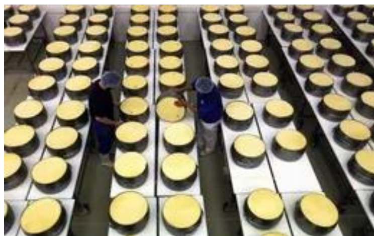
Рисунок 2.14 – Процес формування сиру
