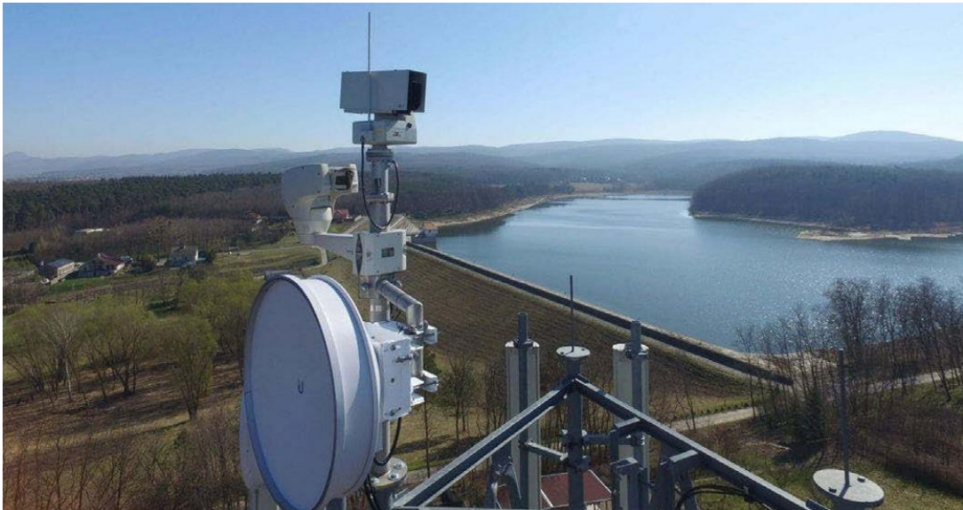
Рисунок 2.9 – Автоматизована система моніторингу з використанням штучного інтелекту IQ FireWatch
