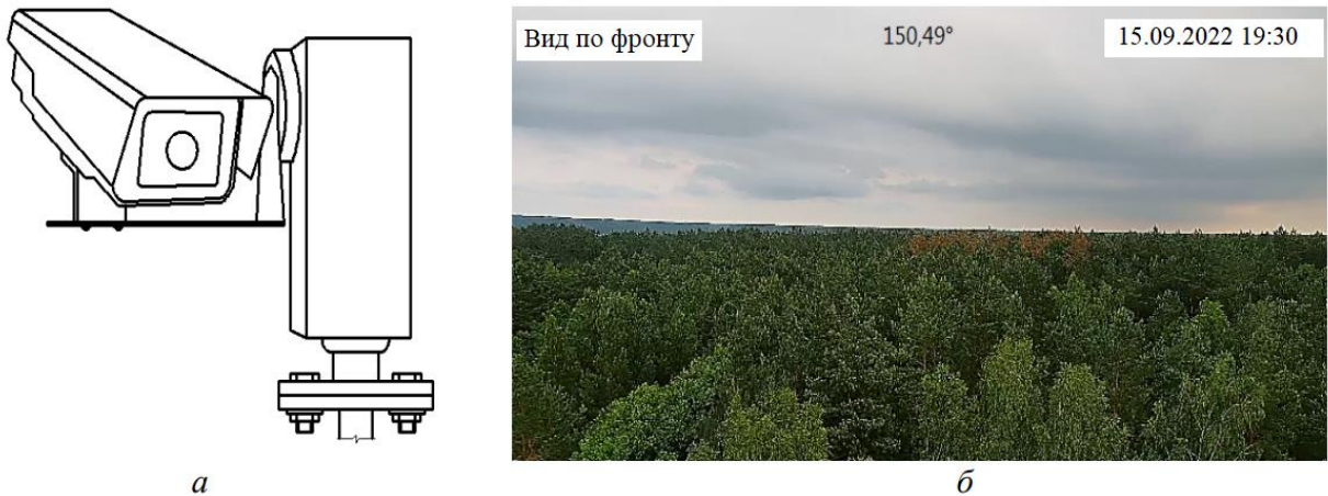
Рисунок 1.9 - ІР-камера на опорно-поворотній платформі з вертикальним кронштейном: а - спосіб монтажу відеокамери на опорно-поворотній платформі, б – панорама лісового масиву без «мертвої зони».
