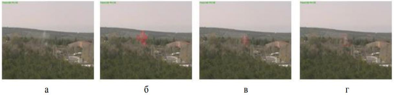
Рисунок 3.5 – Кадри відеопослідовності кадр 116: а) вихідний кадр відеопослідовності під номером 116; б) результати детектування з розміром блоку 8 пікселів (кадр 116), в) результати детектування з розміром блоку 15 пікселів (кадр 82); г) результати детектування з розміром блоку 30 пікселів (кадр 88).
