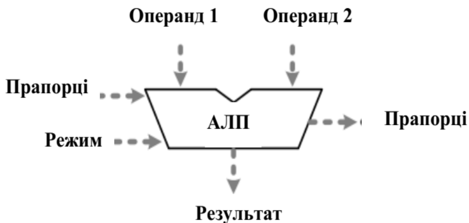
Рисунок 1.4 - Узагальнена блок-схема АЛУ
