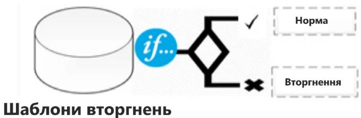
Рисунок 2.1 – Принцип роботи сигнатурних IDS
