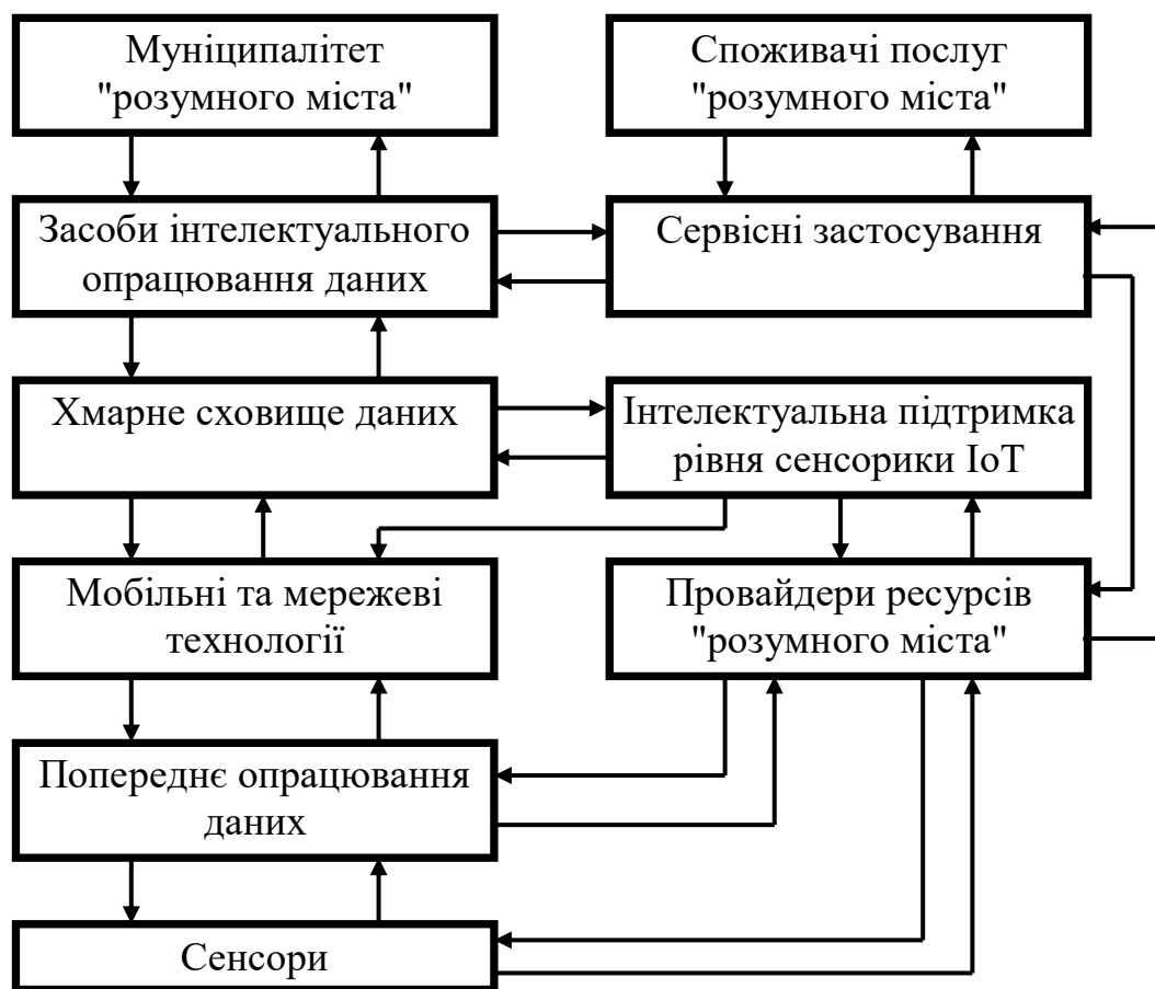
Рисунок 1.2 - Узагальнена структура вимірювального каналу у складі технології Інтернету речей (на прикладі «розумного міста»)
