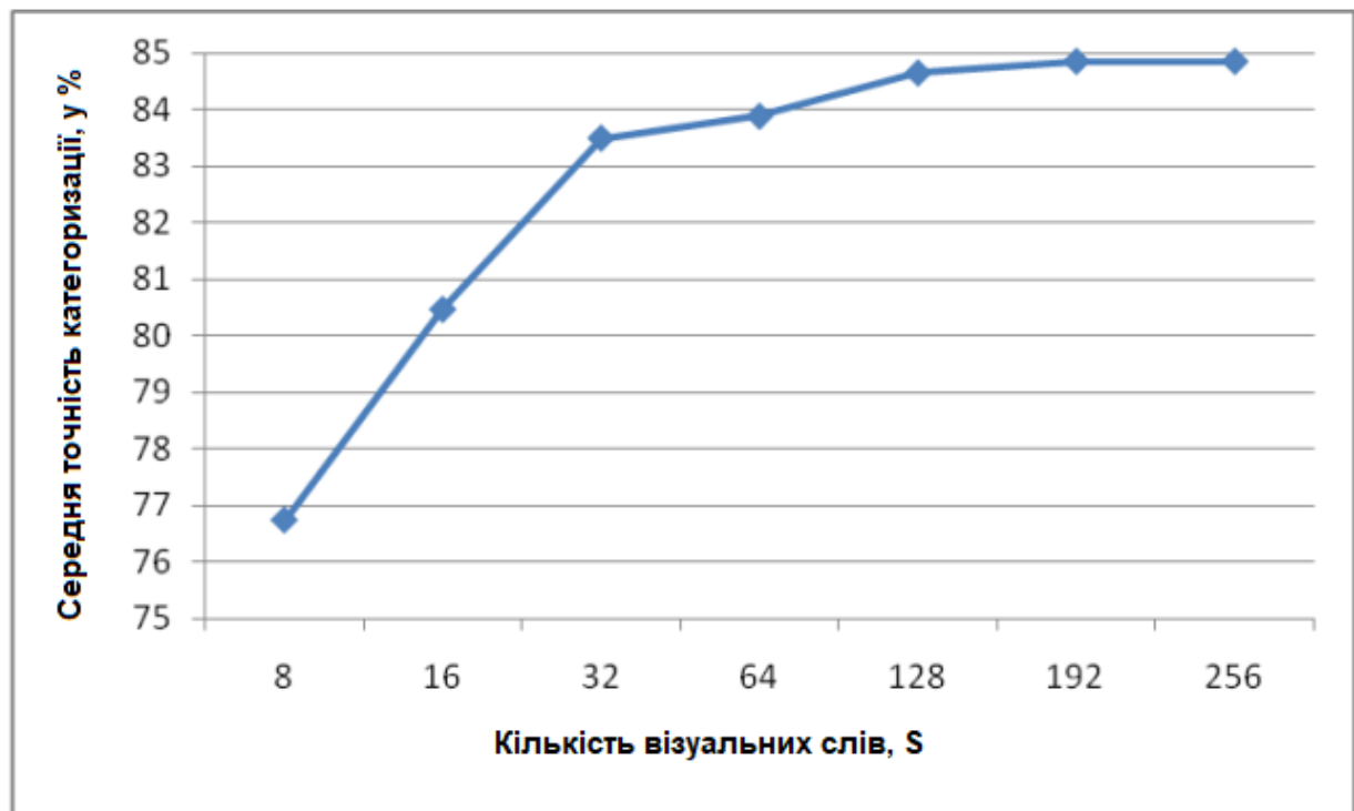
Рис. 3.5. Графік залежності середньої точності категоризації зображень від розміру словника візуальних слів ( \gamma = 1 )
