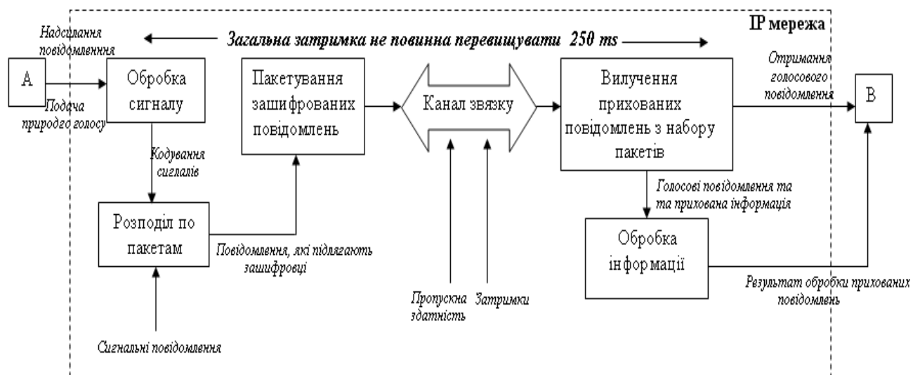
Рис. 2.1. Схема стегосистеми як системи передачі зв'язку з додатковою інформацією
