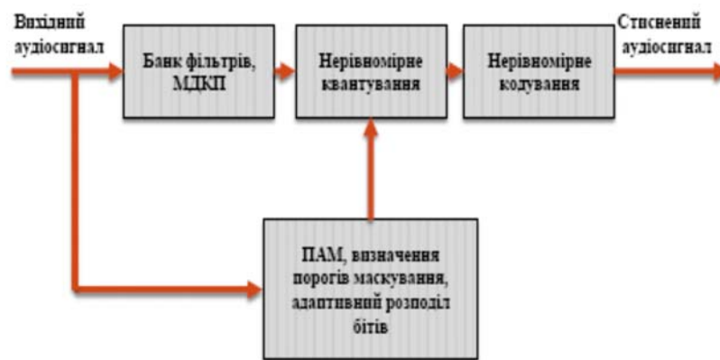
Рис. 2.3. Узагальнена модель кодів стиснення з втратами звукових сигналів
