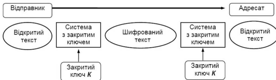
Рис. 1.5. Симетрична схема криптосистеми
