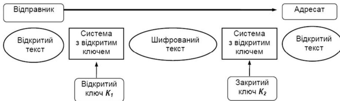
Рис. 1.4. Асиметрична схема криптосистеми
