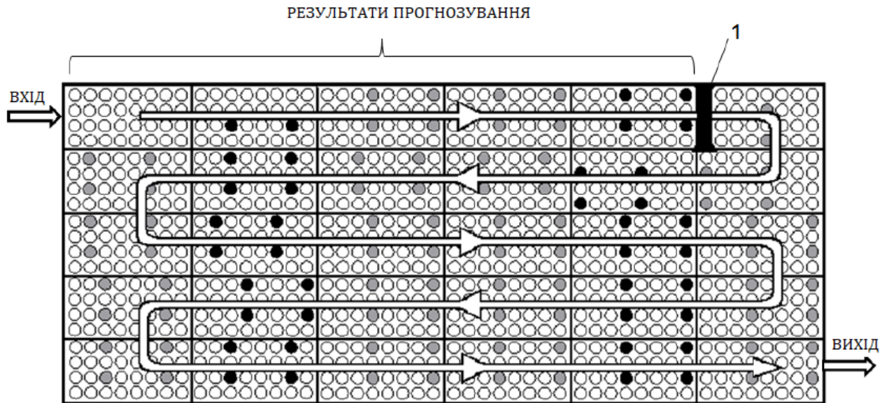
Рис. 3.11. Стан першого шару рекурентної нейронної мережі другого типу під час прогнозування методом без часових зрушень
